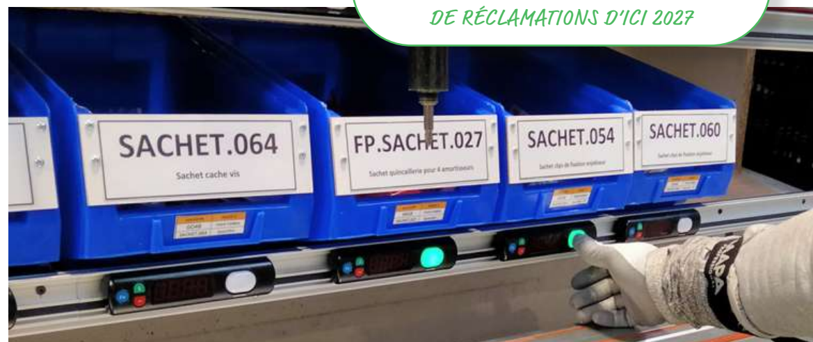
Le pick-to-light, un système de voyant de couleur adapté pour aider les opérateurs
