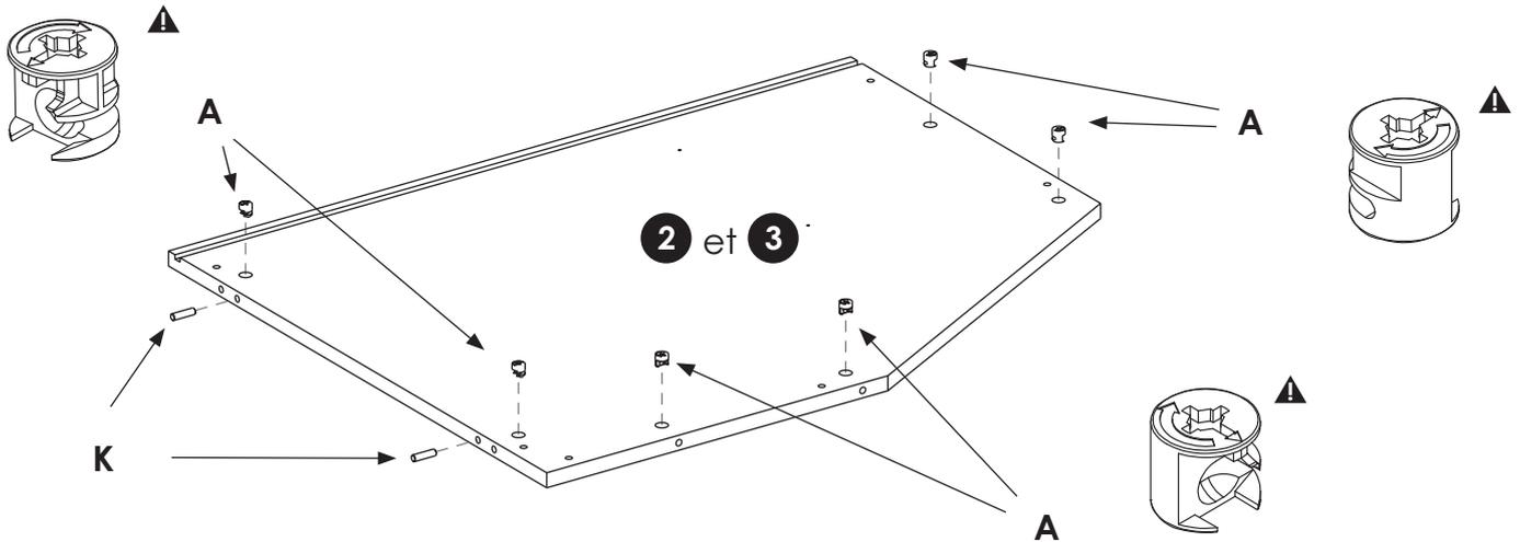
▲ À l'orientation de la flèche des excentriques.
