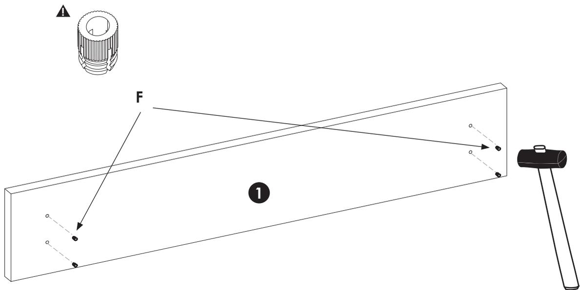
⚠ À l'orientation de l'insert F. Ils doivent être affleurants à la surface.
