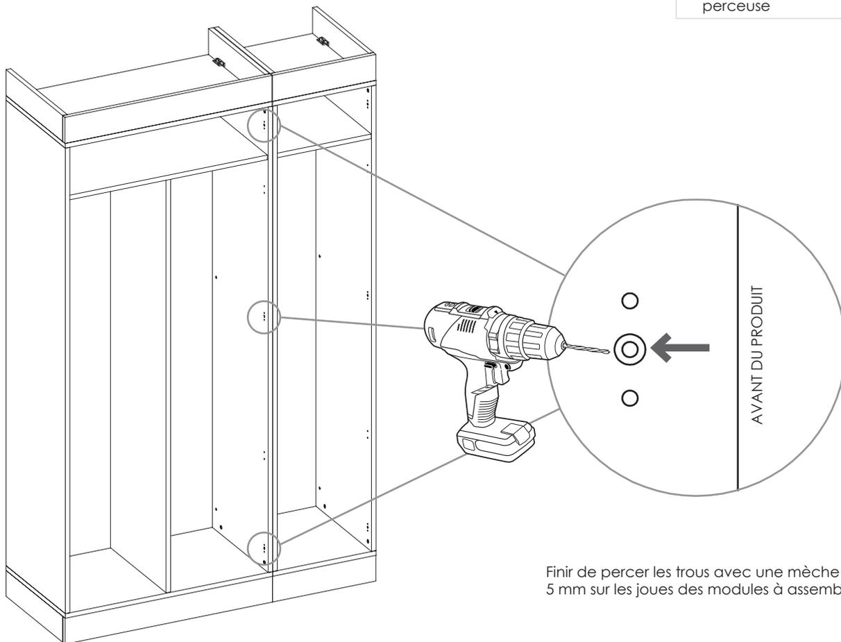
Finir de percer les trous avec une mèche de 5 mm sur les joues des modules à assembler.
