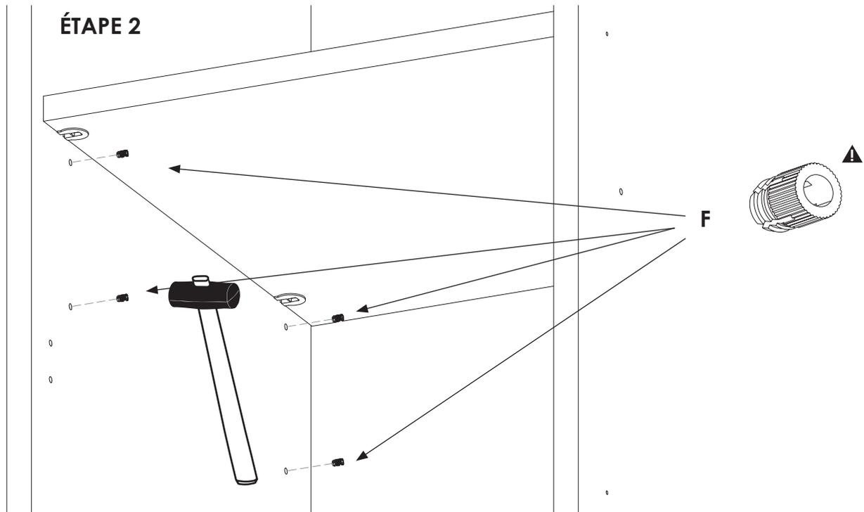
⚠ À l'orientation de l'insert F. Les Positionner sur les joues qui supportent les portes. Les inserts doivent être affleurants à la surface.
