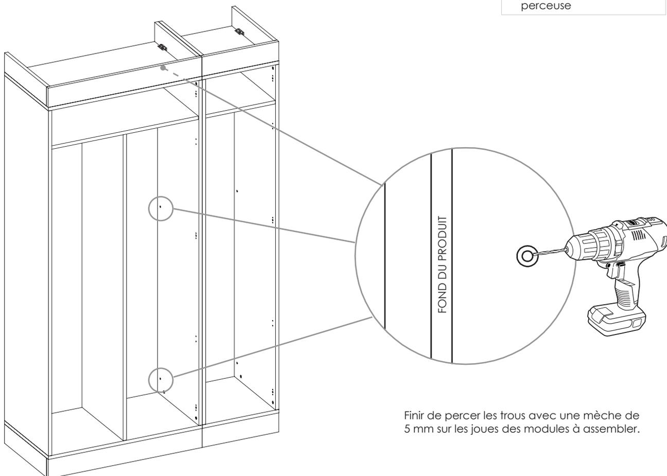
Finir de percer les trous avec une mèche de 5 mm sur les joues des modules à assembler.
