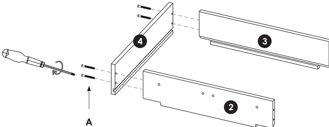
Les vis **A** doivent être affleurantes à la surface du côté **4**.
