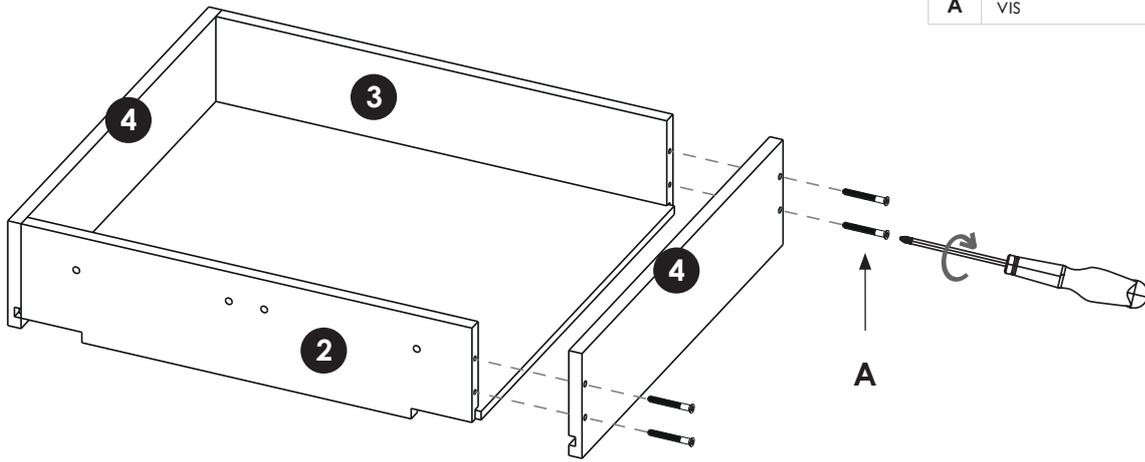
Les vis **A** doivent être affleurantes à la surface du côté **4**.
