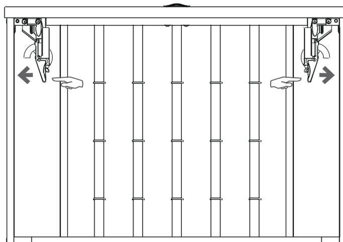
Pour retirer le porte pantalons des coulisses, il faut le déverrouiller en exerçant une pression sur les gachettes vers l'extérieur.
