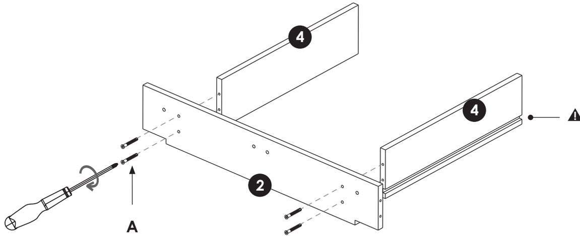
Les vis **A** doivent être affleurantes à la surface de la face avant **2**.
