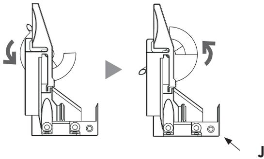
Il est possible de régler la hauteur de la façade du porte pantalons. Selon le sens de rotation donné à la **molette verte** de la gachette **J**, cela fait remonter ou descendre la caisse du porte pantalons sur les coulisses et donc remonter ou descendre la façade.
