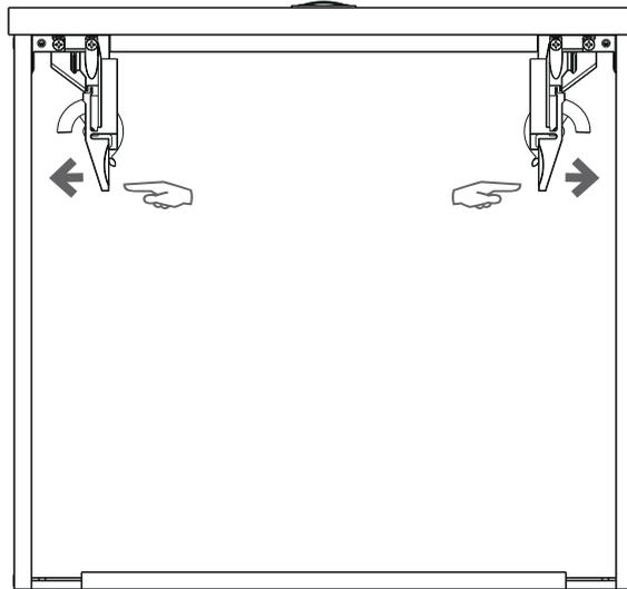
Pour retirer le tiroir des coulisses, il faut le déverrouiller en exerçant une pression sur les gachettes vers l'extérieur.
