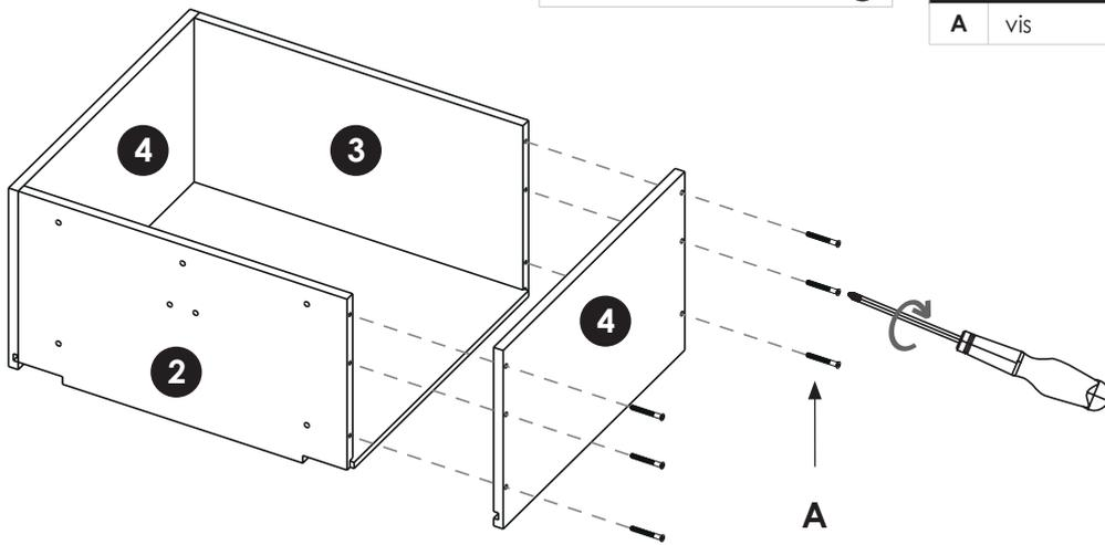
Les vis **A** doivent être affleurantes à la surface du côté **4**.
