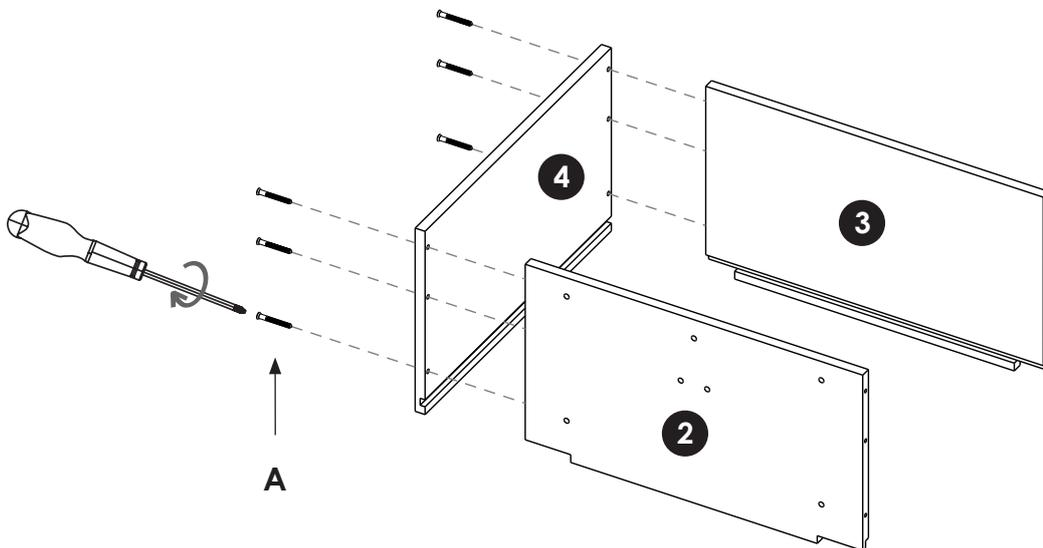
Les vis **A** doivent être affleurantes à la surface du côté **4**.
