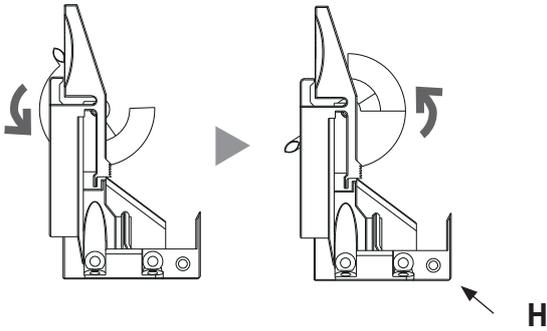
Il est possible de régler la hauteur de la façade du porte pantalons. Selon le sens de rotation donné à la **molette verte** de la gachette **H**, cela fait remonter ou descendre la caisse du porte pantalons sur les coulisses et donc remonter ou descendre la façade.
