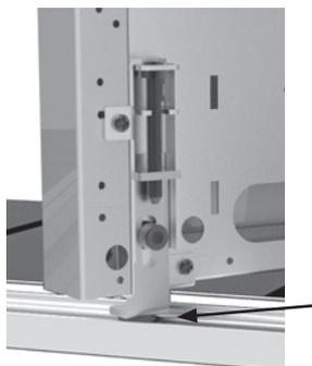
**Remarque :** une fois réglée, l'ouverture et la fermeture de la porte s'effectue sans à-coup. En cas de point dur, augmenter la distance entre le rail et les mécanismes avec embout nylon.
